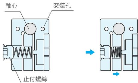
鬆開的狀態下將軸心插入，在安裝孔上將本體鎖固之
